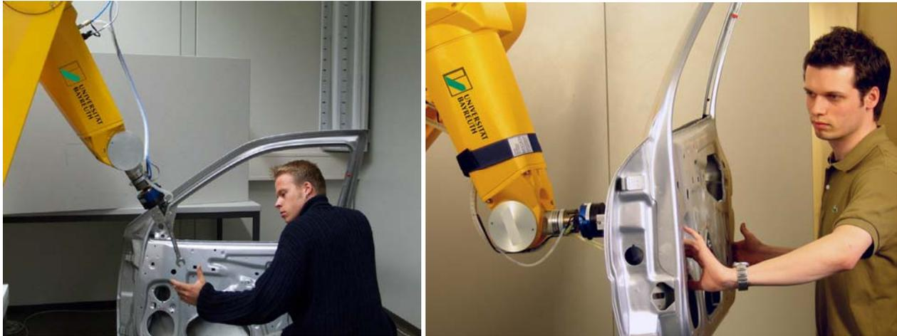
**Abbildung 1:** Sichere Mensch/Roboter-Kooperation durch autonome, kollisionsfreie Roboterbewegungen bei Hol- und Bringdiensten (links) oder durch Halten von schweren Werkstücken mit Führung des Roboters durch den Menschen (rechts)
