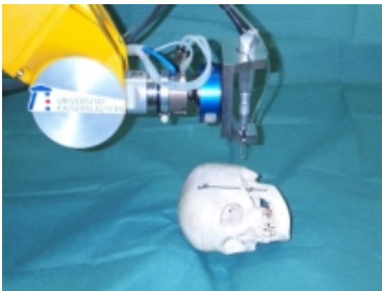
Fräsroboter mit Kraftsensorik im Detail und in Aktion
